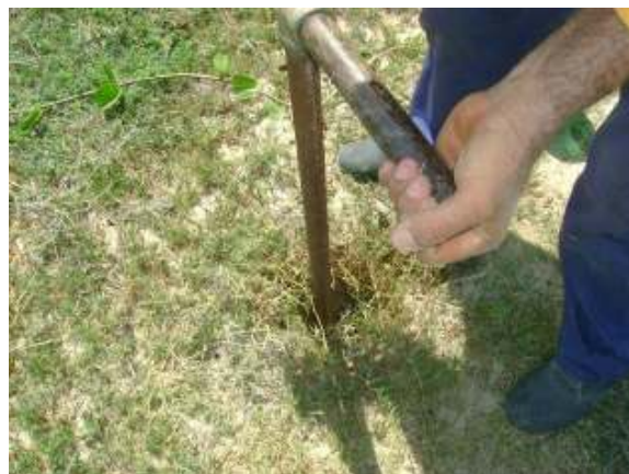
Foto 06 – Detalhe de um dos furos de sondagem feito com trado.
