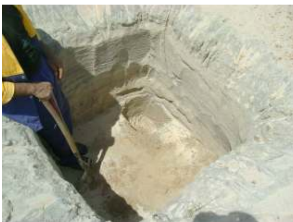
Foto 07 – Detalhe da profundidade e tamanho da vala usada no estudo geotécnico.
