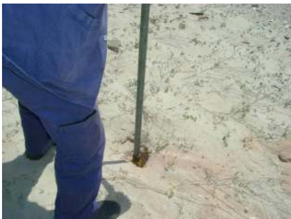
Foto 05 – Execução de furo de sondagem com trado.
